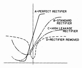
Fig. 43. Effects of rectifier leakage.
