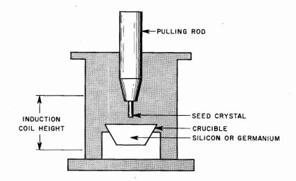
Fig. 82. Crystal-pulling apparatus.
