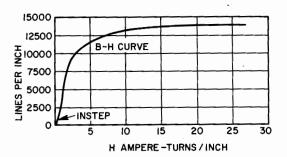
Fig. 20. B-H curve for iron.
